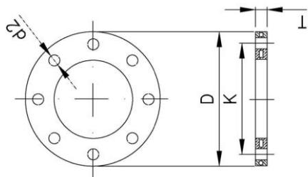
رینگ فولادی با پوشش پلیمری تقویت شده
