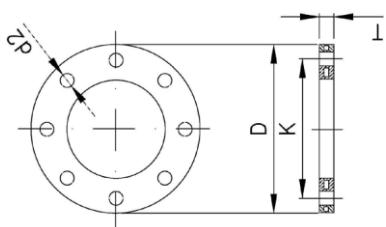
رینگ فولادی با پوشش پلیمری تقویت شده
