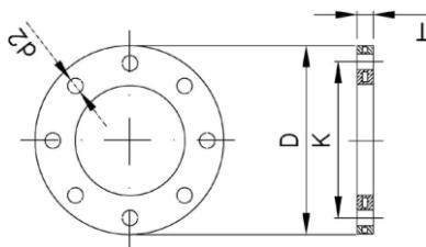
رینگ فولادی با پوشش پلیمری تقویت شده
